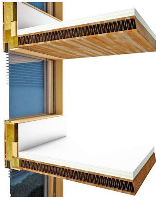
Abb. 5.5: Prinzipielle Ausführung der geschossübergreifenden Installationsführung
